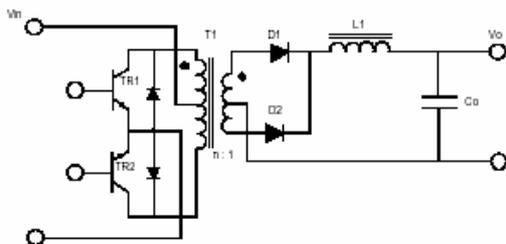
Fig. 1 Push-Pull Converter
